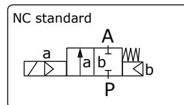
**ANSCHLUSSPLAN wiring diagram**
